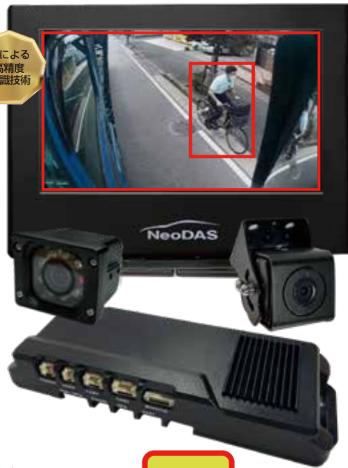
AI サイドカメラで巻き込み事故の危険をアラートします。
